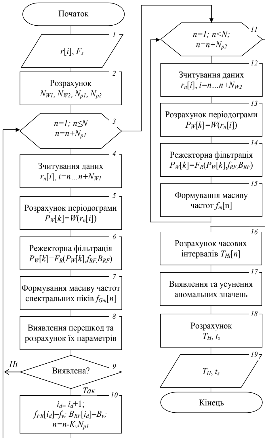
Рис. 2. Схема методу визначення часових параметрів сигналів із ППРЧ на фоні вузькосмугових перешкод
